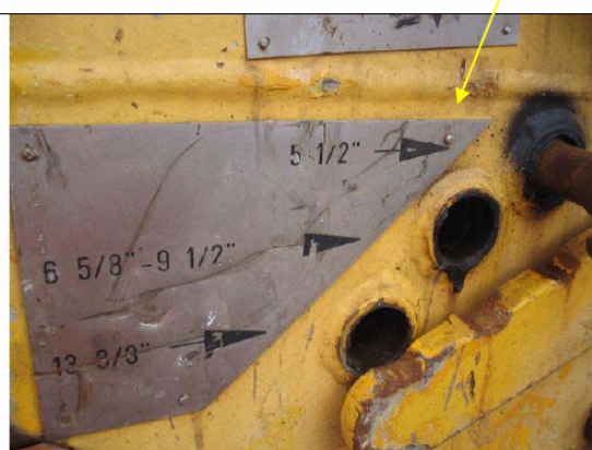
Figur 4 Innstilling av gripeklør
