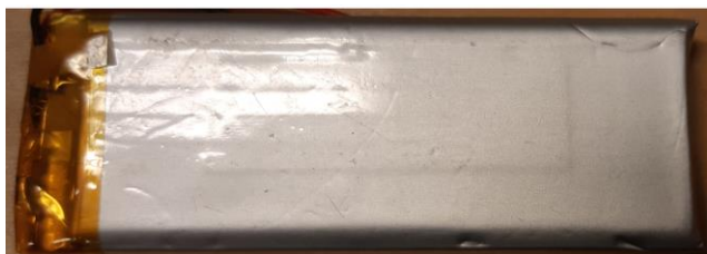
Figur 2 Typisk celle for litium ion batterier, en batteribank for bruk offshore kan bestå av flere tusen slike celler
