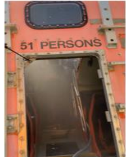
4. Røyk / avdamping fra isolasjonsmaterialet
