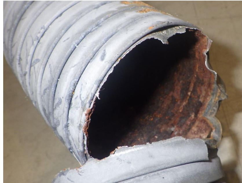
3. Eksoslekkasje fra spiralslange (åpnet for illustrasjonsformål),
