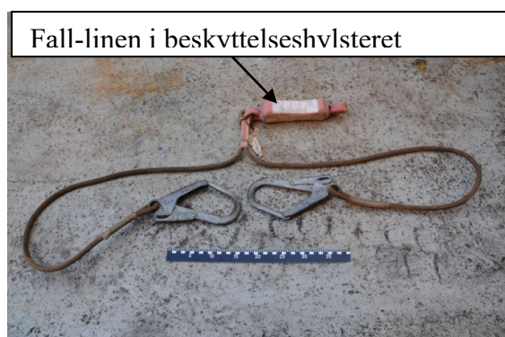
Bilde 2 viser Y-linen med krok 1 og krok 2
