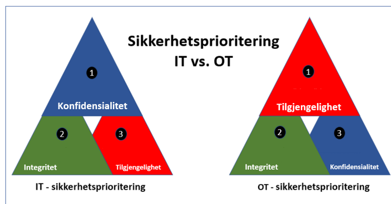
Figur 6 "CIA-triaden" - Ulik sikkerhetsprioritering for IT og OT-system
