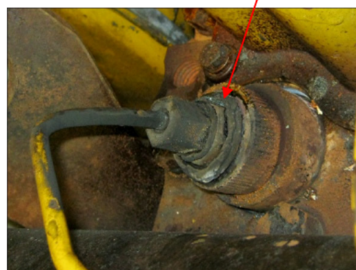
Figur 4 Kranmaskinrom PCP, motor A til venstre og detaljer innsprøytningsdyse for sylinder nr 6
