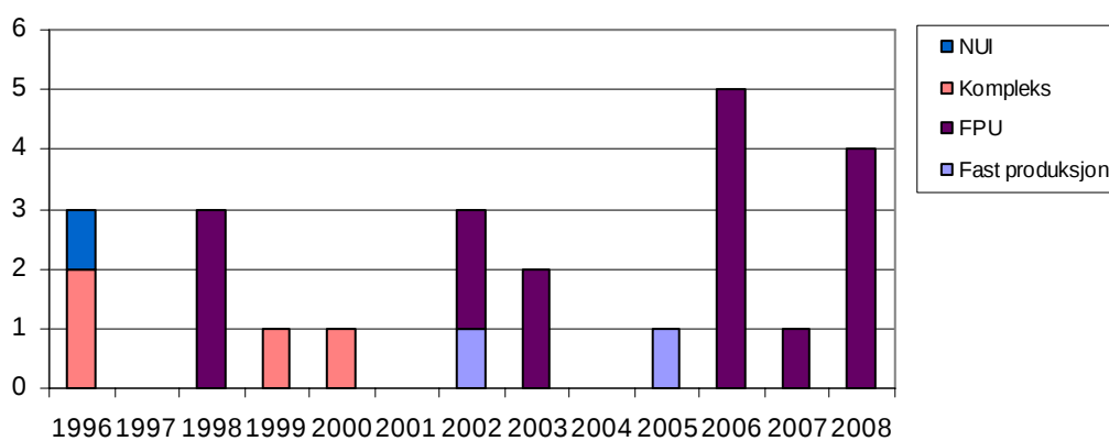
Figur 61 Antall "major" skader på stigerør og rørledninger innenfor sikkerhetssonen, 1996-2008
