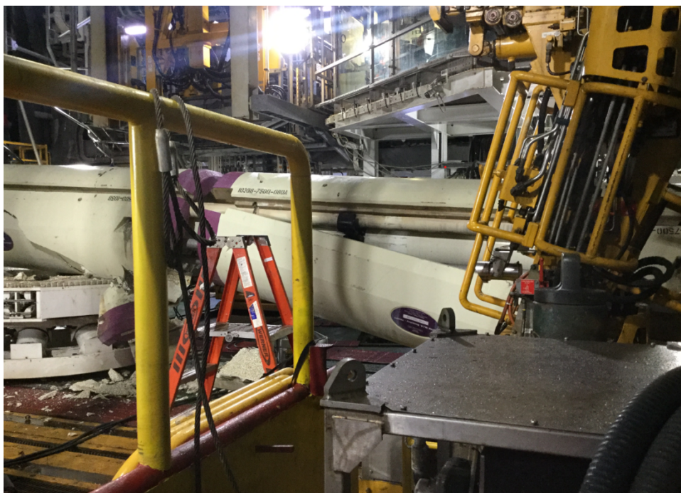
Bilde 3: Bildet viser stigerøret liggende på boredekk og oppå arbeidsbordet etter hendelsen. Borebu sees i øvre del av bildet. Bildet er hentet fra Seadrill sin presentasjon av hendelsen.
