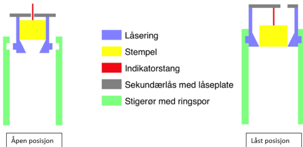
Tegning 4: Viser en forenklet framstilling av stigerøret i grønt, og løfteverktøyet i lilla, rødt, gult og grått.
