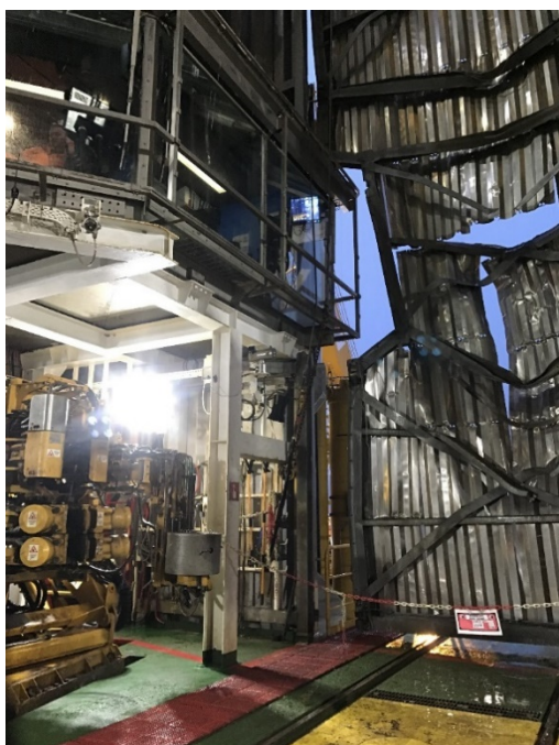
Bilde 2: Bildet viser borebu og skade på V-dør hvor stigerøret traff. Bildene er tatt om bord av Ptil sin granskingsgruppe.
