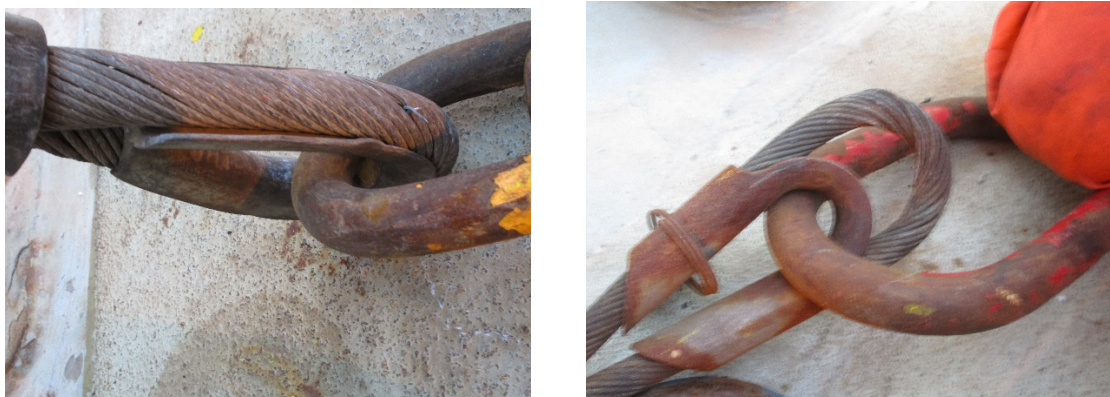
Bilde 13: Skader på kranforløpere som ble brukt under håndteringen av pumpen og kabelen fra dekket til taket av ventilasjonshuset
