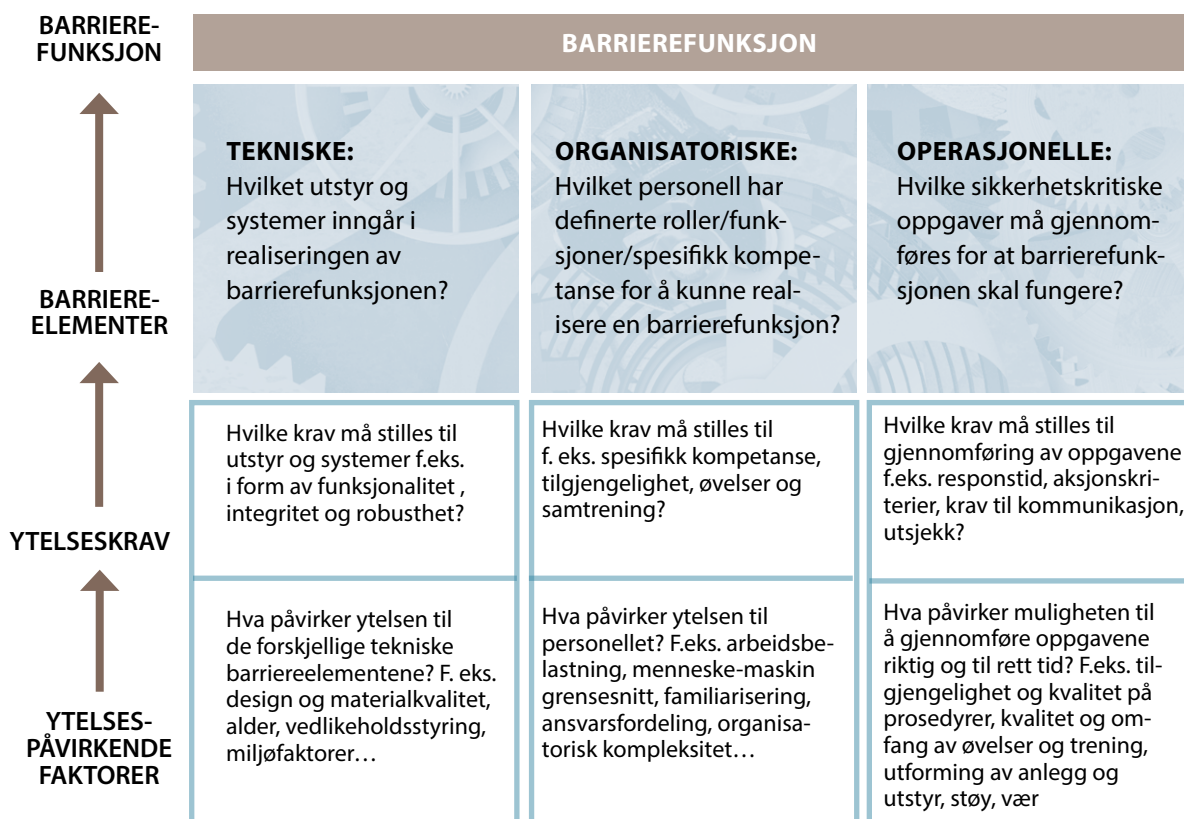
Figur 7: Illustrasjon av hvordan en barriererefunksjon kan ivaretas i samspill mellom tekniske, organisatoriske og operasjonelle barriereelementer, ytelseskrav til elementene og ytelsepåvirkende faktorer
