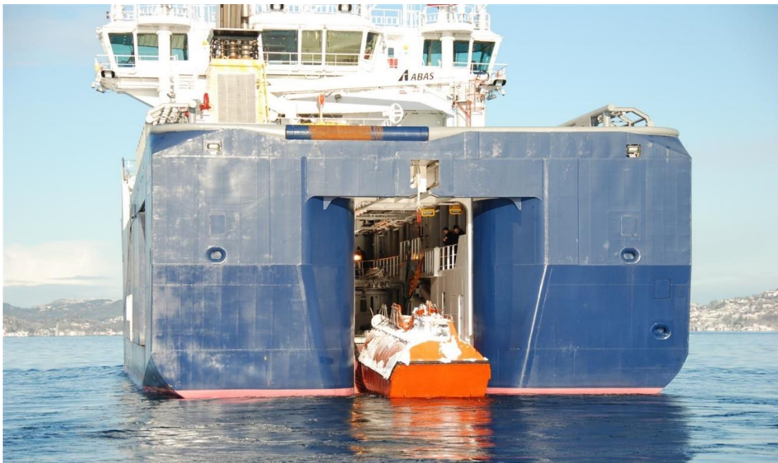
Figur 5.16 Inntak av livbåt i områdeberedskapsfartøy (Foto: mokster.no)
