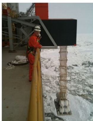
Figur 10-16 VIKING arktisk evakueringsstrømpe løsning og tilhørende redningsflåter (ref. www.vikinglife.com )
