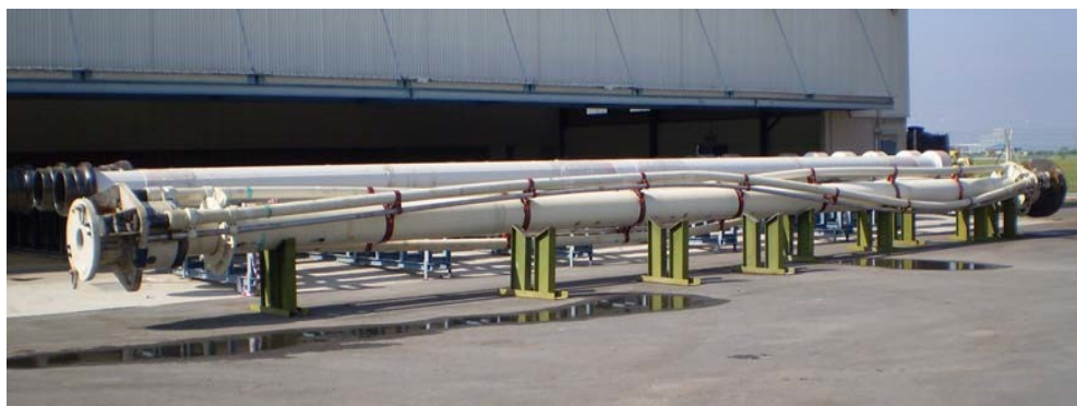
Figur 8-21 Borestigerør med K&C lines (Aker Solutions)
