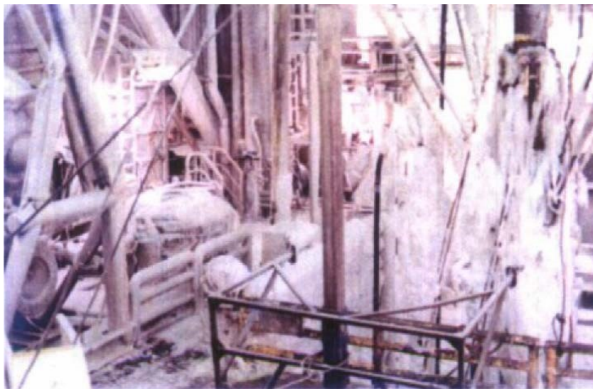
Figur 7-2 Isopphoping på objekter med mindre diameter på halvt nedsenkbare «Ocean Beauty» (Ref. [3])
