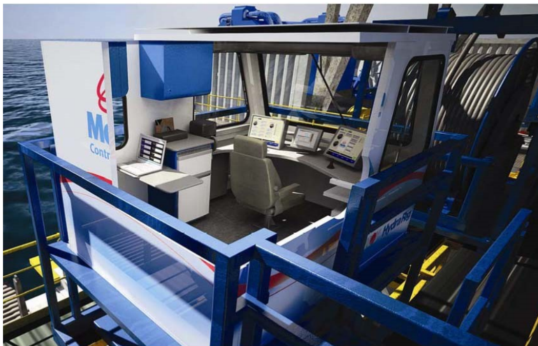
Figur 8-34 Lukket og oppvarmet Coiled tubing operatør stasjon med trommel (NOV)
