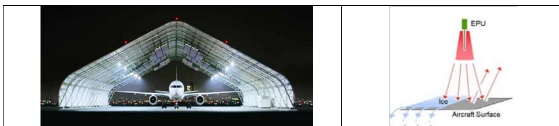
Figur 7-12 (Venstre) Infrarød avisning teknologi installert i et fly hangar (ref. http://www.iasa.com.au/folders/Safety_Issues/RiskManagement/infrareddeicing ), (Høyre) virkemåten til InfraTek™ Deicing System
