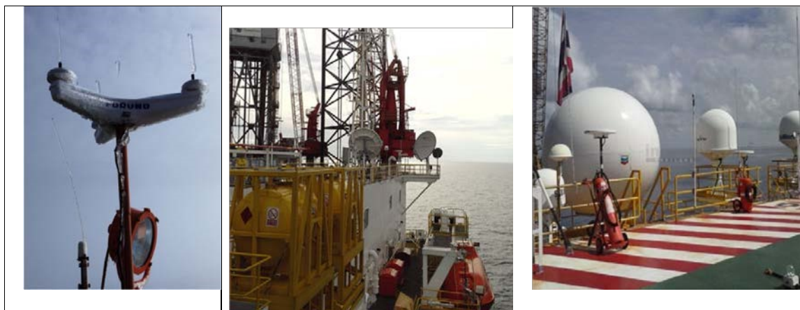
Figur 9-2 Venstre) Bilde av nediset kommunikasjonsutstyr (Ref. [33]), (Midten) værekspont antenner, (Høyre) Antenner plassert i kupler (Ref. Infonet Thailand webside)
