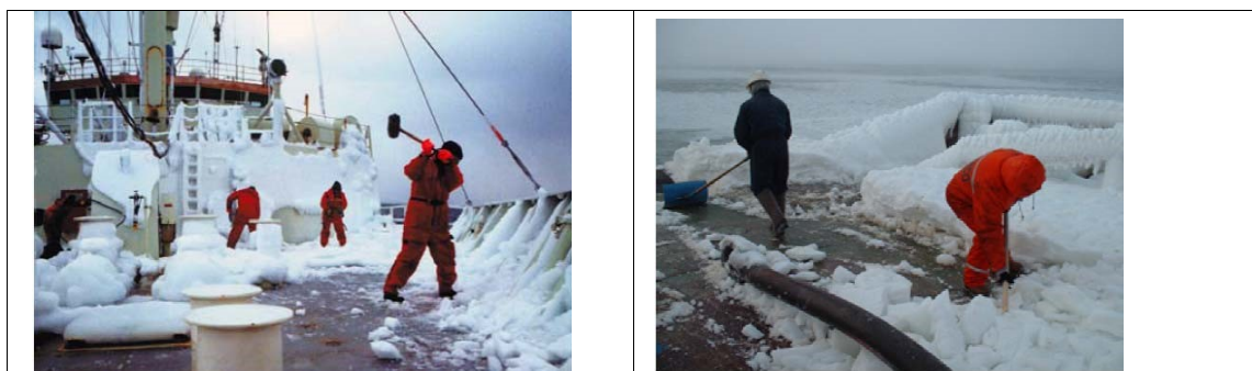
Figur 7-15 Manuell avising på skipsdekk (venstre ref. [33] høyre ref. [34])
