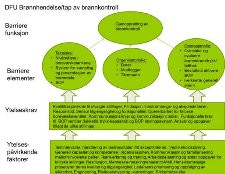
Figur 13-2 Sammenheng mellom tekniske, organisatoriske og operasjonelle barriere-elementer for brønnkontroll (ref. [72])
