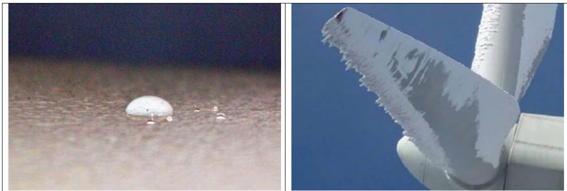
Figur 7-9 Isdannelse og Isbelegg på vindturbiners blader (Ref. http://www.yceblades.it/en/solution-lab )
