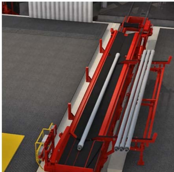
Figur 8-6 Horisontal rørhåndtering, mating til boredekk / Tubular Feeding Machine
