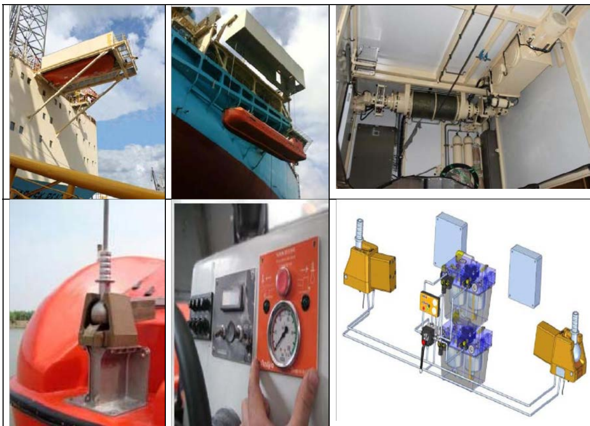
Figur 10-9 Nadiro Boat-In-A-Box løsning med Drop-In-Ball System (ref. Nadiro presentasjon)
