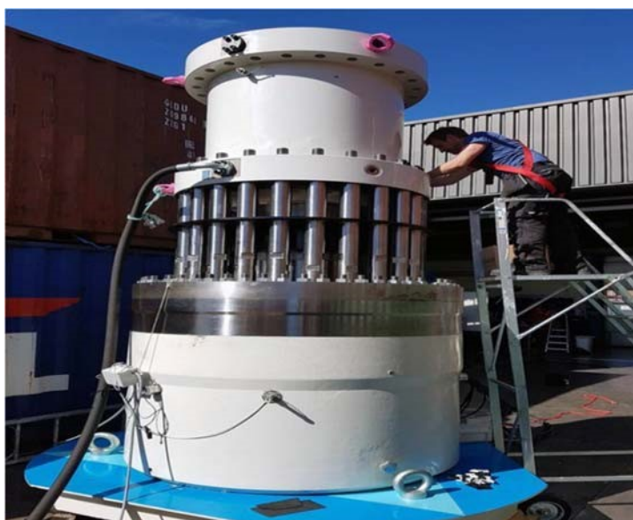
Figur 8-16 Bilde CCC Elektrisk aktuert BOP prototype (Electrical Subsea& Drilling- ESD)
