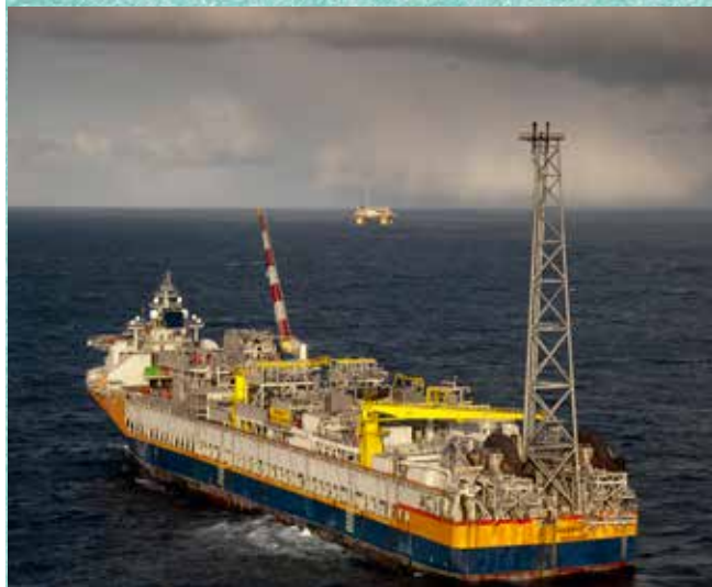
Produksjons- og lagerskipet Åsgard A (bildet) er en av tre flytende innretninger på Åsgardfeltet. Nede på havbunnen er det boret over 50 havbunnsbrønner. (Foto: Øyvind Hagen/Equinor)
