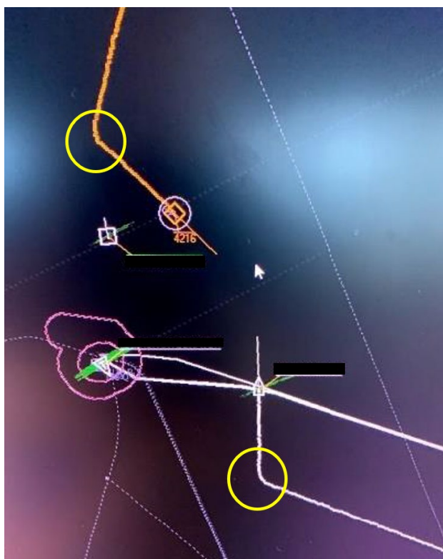
Figur 5-6 Eksempel på «ghost vessel». Hvit rute fra nedre høyre hjørne for faktisk fartøy. Oransje rute representerer ikke noe fartøy, skyldes kun speiling av radarekkoet.
