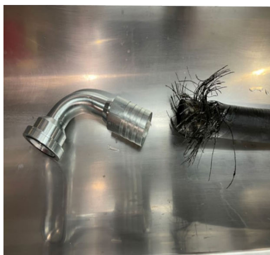
Bilde 10: Presskobling med enden av hydraulikkslangen (Kilde: Equinor/Island Offshore)
