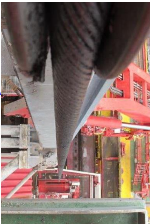
Figur 6: Skeivtrekket mellom trommelen og skivehjulet
