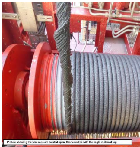
Figur 3 Skade på ståltauet til HTV Eagle-kranen. Synergi # 1461090, januar 2016
