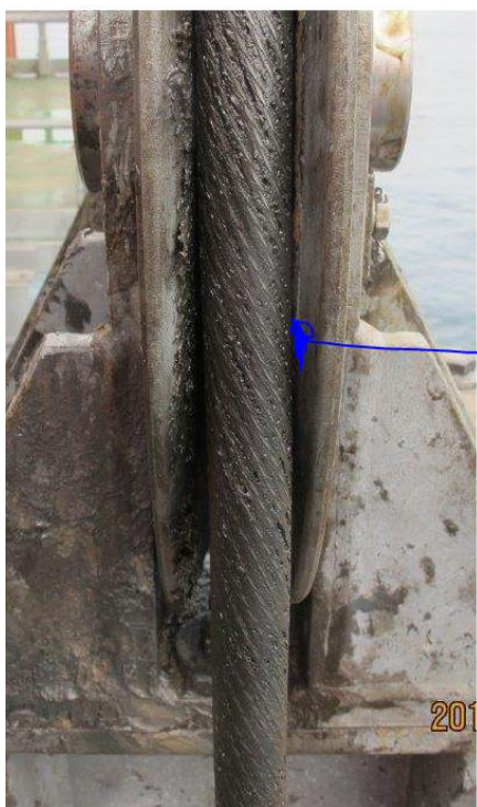
Figur 5: Ståltauet ligger an mot skivehjulet
