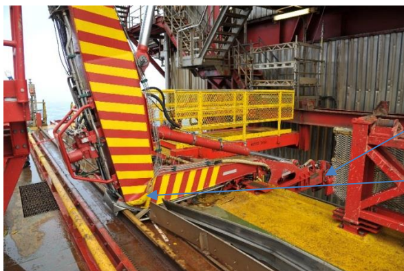
Figur 10 Kranen med bøyd kranarm og knekt gripearordning
