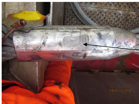
Bilde 2- Skadet presslås til forløper til offshorekran
