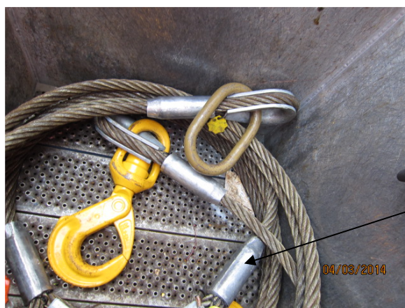
Bilde 1 – manglende inspeksjonshull i presslås
