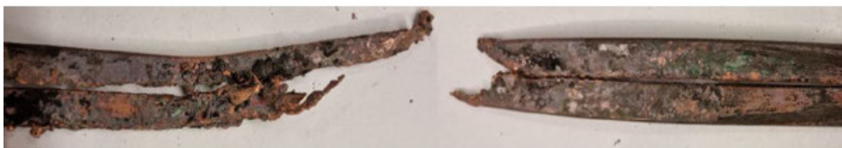
Figur 14: Defekt/smeltet kobbervikling på sekundærsiden lokalisert i toppen av den midtre spolen
