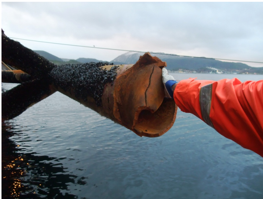
Figur 29: Bolster 4 med skade «A» (jamfør Figur 27). Her er tre elementer borte. Det første bruddet hendelsesnatten antas å ha oppstått her klokken 23:40 den 6. november, da ankervinsjalarmene om overlast stoppet. Ankeret kan frem til da ha dratt med 70-80 tonn last i det horisontale bolsterelementet «A-B» (se Figur 27). Bruddet har utviklet seg fra de tidligere skadene, som forventes å ha oppstått i det nederste skråstaget (se Figur 28). Bruddet i bolsteret har medført at lasten fra ankeret er blitt redusert, og at ankeret har kommet i bevegelse. Det er mulig at bolsterdelen mellom «A» og «B» har stått igjen en stund. Etter ca. to timer har ankeret hatt adgang til å slå inn i skroget. Fram til da, har bolsteret fått enda et brudd i sveisen ved punkt «B», og bolsterdelen på ca. 1,5 tonn er falt til bunns. Klokken 01:40 har begge skråstagene vært til stede, og det øverste antakelig fremdeles festet i punkt «B» (hvor hånden på bildet holder i en del som er bøyd senere enn 01:40). Bildet er tatt i Kristiansund 12. november 2012 av Ptil.
