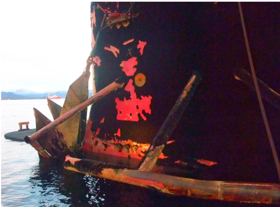
Figur 3: Anker nummer 8 og skadene over vannlinjen, her i transittdypgang. På bildet ses anker som har laget skadene og det delvis ødelagte bolsteret. Bildet er tatt 10. november 2012, i Kristiansund av Ptil.
