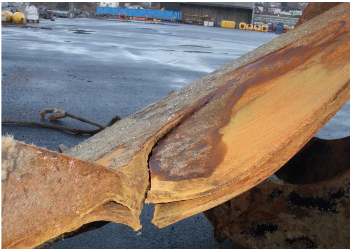
Figur 10: Bilde av skader på anker nummer 8 på Floatel Superior, i Kristiansund 14. november 2012. Foto: Ptil.
