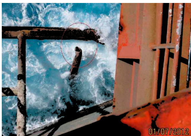
Figur 46: Avkuttet stag i bolsteret på West Hercules 1.7.2012. Foto: Seadrill [128].
