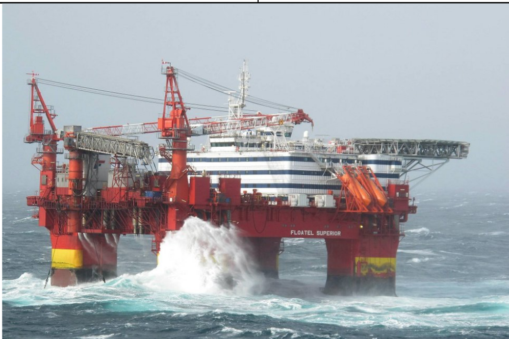
Figur 1: Bilde av Floatel Superior i overlevelsesdypgang (13m). Fribord (engelsk air gap ) er 14,5 meter fra sjø-nivået til undersiden av dekket (under teksten "FLOATEL SUPERIOR" på bildet). Sjøsprøyten fra bølgen i forgrunnen rekker opp til vinsjtrommelen på vinsj nummer 4 (med ankerline 8), ved fremre babord søyle. Bildet er tatt i en tidligere situasjon med uvær. Copyright Erik Sevaldsen 1 .
