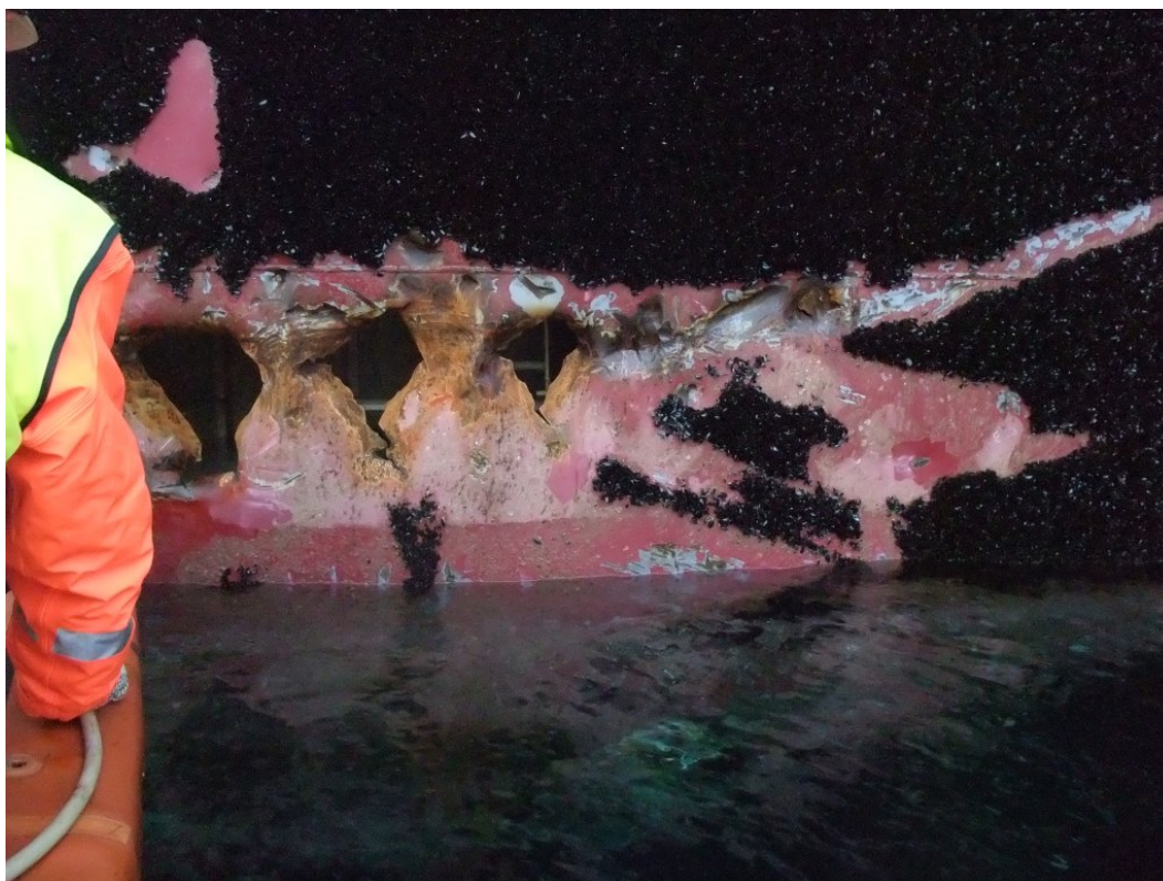
Figur 38: Hullene og gjenstående blåskjellbegrøing (svart). Skrapemerker etter ankerspisser på skrå oppover til høyre i bildet, viser tydelige spor etter ankerets pendelbevegelse. Bildet er tatt i Kristiansund 12. november 2012 av Ptil.
