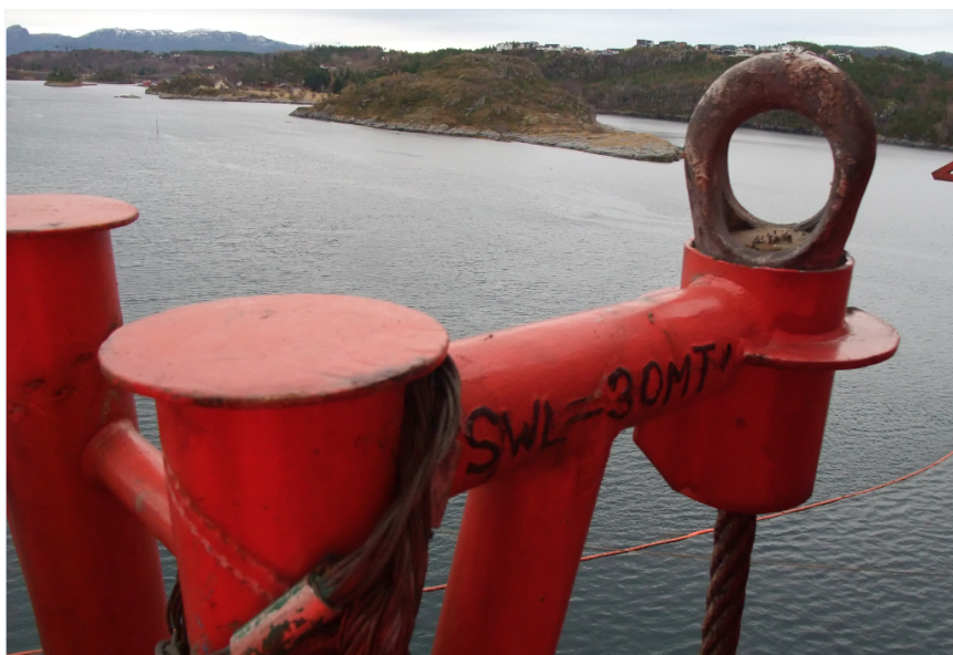
Figur 15: En intakt opphengning av en pennantwire på Floatel Superior. For å frigjøre wiren løftes løkken med kran og trekkes ut fra skroget. For line 8 ble hele stålkonstruksjoner revet av, både festet og rekkverket. Bildet er tatt i Kristiansund av Petroleumstilsynet 13.11.2012.
