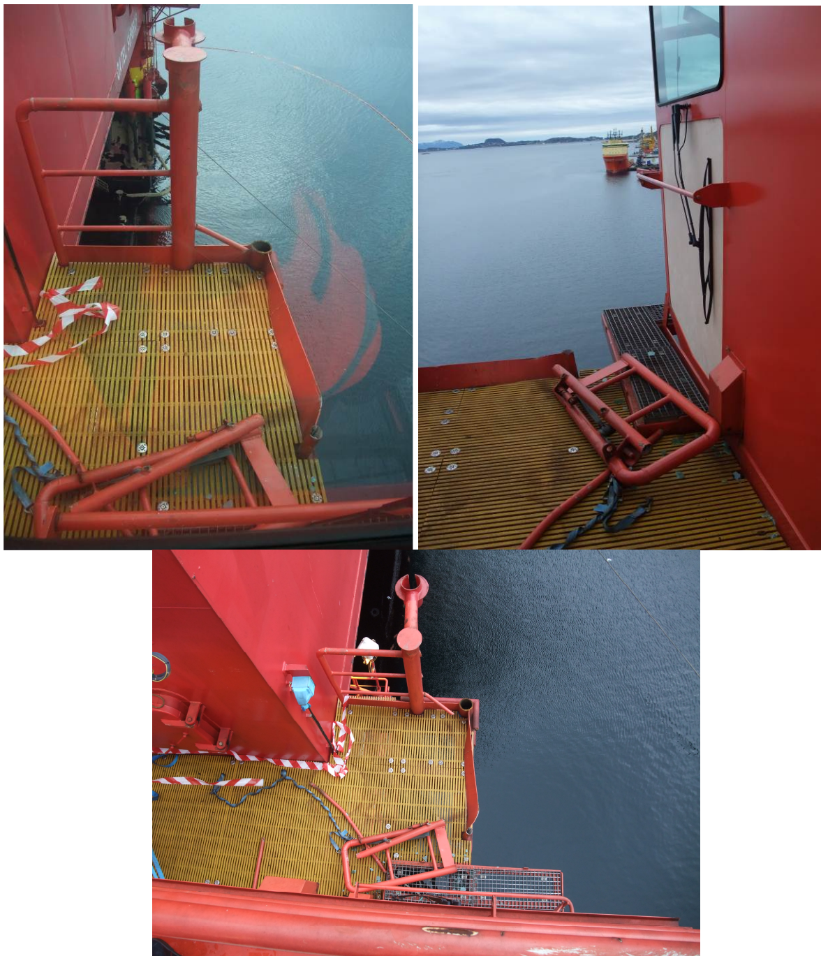
Figur 43: Området ved manøvreringshuset der pennantwiren ødela festet til wiren, rekkverket og vinduet inn til manøvreringshuset. Det ødelagte vinduet er her dekket med en treplate. Festet for pennantwire nr. 7 står igjen. Bildene er tatt av Ptil i Kristiansund i november 2012.
