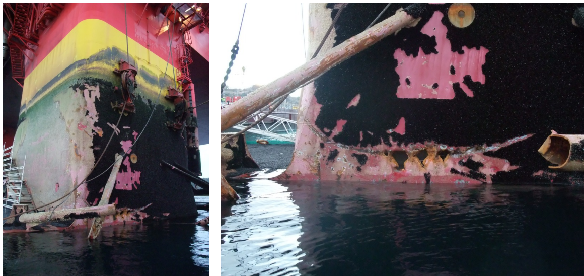
Figur 36: Skader over transittdypgangen med fem hull i skrogsiden og ett framme på søylen. Alle seks fra penetrering av ankerflyenes spisser. Bemerk at områdene hvor ankeret og wiren har beveget seg er tydelig markert ved avskrapninger (rød bakgrunn) av blåskjell (svart farge). Bildene er tatt i Kristiansund 12. november 2012 av Ptil.
