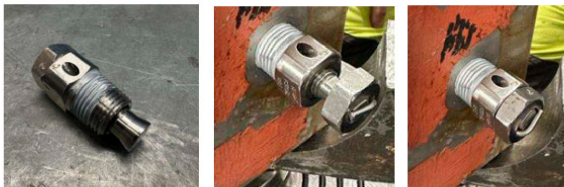
Figur 6 Bildet til venstre viser type blødeplugg. Bildet i midten viser blødeplugg i stengt posisjon. Bildet til høyre viser blødeplugg i åpen posisjon. (kilde: Equinor Synergi 2531047 Ekstern HC lekkasje i G-område)
